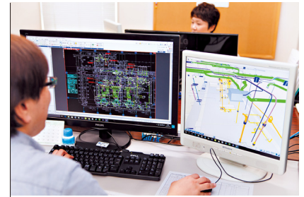
配管の作図や干渉チェックにとどまらず、スリーブの加工図作図や現場への搬入シミュレーションまで、その機能は多彩だ
